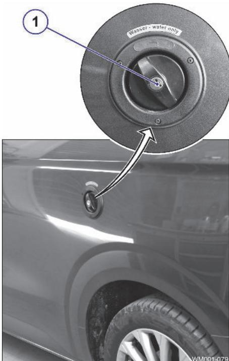
Einfüllöffnung mit verschließbarem Tankdeckel **1** für Frischwasser ist hinten links in der Fahrzeugwand integriert.
